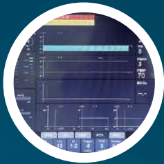
Pantalla TFT LCD de 15" Muestra los parámetros de ventilación, información de alarmas y oscilograma.
